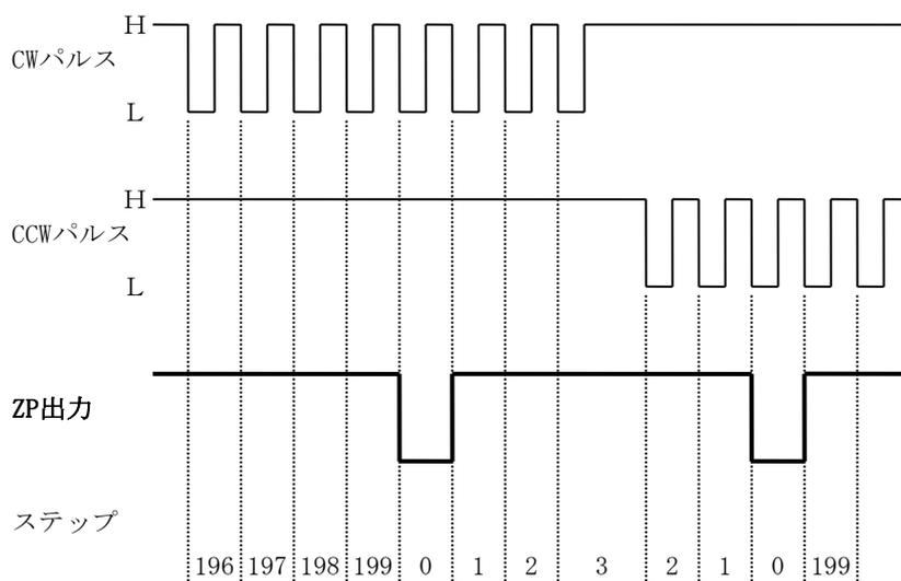
注：Voは30V以下として下さい。外部抵抗R3はコントローラー部の電流仕様に合わせた値にして下さい。最大値は50mA以下として下さい。電源投入後にDS信号を入れてステップ角を切換えて駆動した場合、又はステップ角切換スイッチを操作して異なる値に設定した場合にはZP信号が出力されない場合があります。
