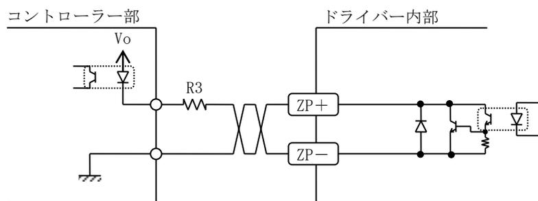
出力回路図及びコントローラーとの接続例を示します。励磁タイミング信号ZPはモーターの励磁シーケンスが（0）の位置であることを示す信号です。装置側の機械原点とモーターの励磁原点（ZP）との一致により、より正確な原点検出を行なう時などに使用します。
